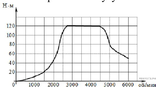
Пользуясь графиком, поставьте в соответствие каждому интервалу количества оборотов двигателя характеристику зависимости крутящего момента двигателя на этом интервале.
