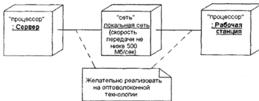
Рисунок 1. Фрагмент диаграммы развертывания с соединениями между узлами
