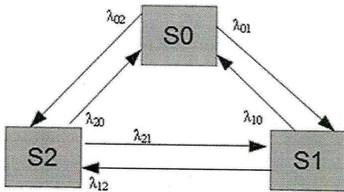
11. Техническое устройство может находиться в одном из трех состояний  $S_0, S_1, S_2$ . Интенсивность потоков, переводящих устройство из состояния, заданы в таблице:
