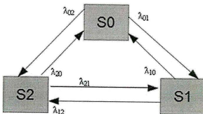
**12.** В заданной матрице  $L$  элемент  $\lambda_{ij}$  есть интенсивность случайного пуассоновского процесса переходов из состояния  $i$  в состояние  $j$  (размерность  $\frac{\text{кол-во переходов}}{\text{единица времени}}$ ).
