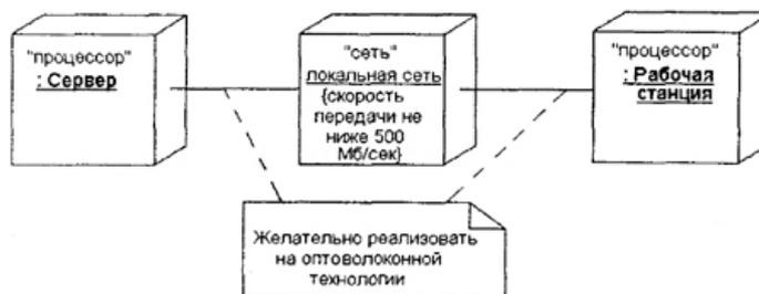
Рисунок 1. Фрагмент диаграммы развертывания с соединениями между узлами
