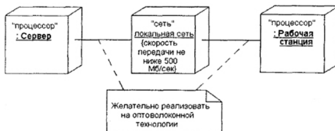
Рисунок 1. Фрагмент диаграммы развертывания с соединениями между узлами
